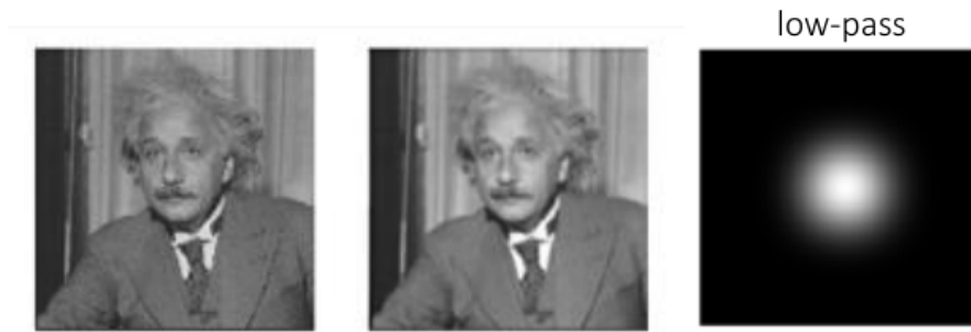
Figura 4.2: Ejemplo filtro de paso bajo (LPF)
