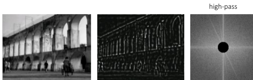
Figura 4.3: Ejemplo filtro de paso alto (HPF)
