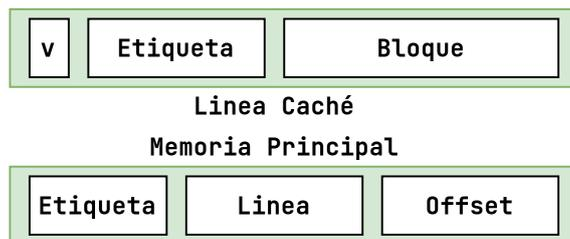
Supongamos por tanto por ejemplo (ignorando bit de válido) que tenemos una caché de 128KB  $\rightarrow$  16 bits, con un tamaño de bloque de 64B  $\rightarrow$  6 bits, entonces tendremos  $2^{10}$  líneas, es decir, necesitamos 10 bits para la línea y el resto del tamaño es para el campo de etiqueta. Esto trae como ventaja la simplicidad y el bajo coste, sin embargo, si dos o más bloques, utilizados alternativamente, corresponden al mismo marco de bloque, se producirán fallos de caché.
