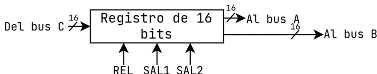
Donde en REL se carga del bus C, y en SAL 1 y 2 se tiene la salida a los buses A y B. Veamos ahora las señales y buses de MAR y MBR con más detalle:
